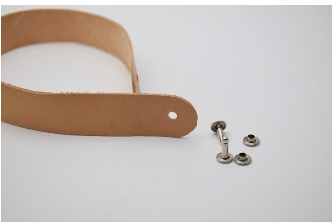
17. Klip din læderrem til og rund evt. hjørnerne af. Lav hul til nitterne med en hultang
