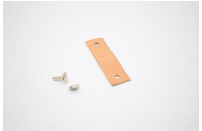
22. Klip din læderrem i stykker a ca. 6 cm. Lav et hul i begge ender.
